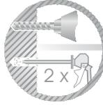
Bohrloch bohren (siehe unter technische Daten). Bohrloch zweimal mit Druckluft (>6bar) reinigen.
